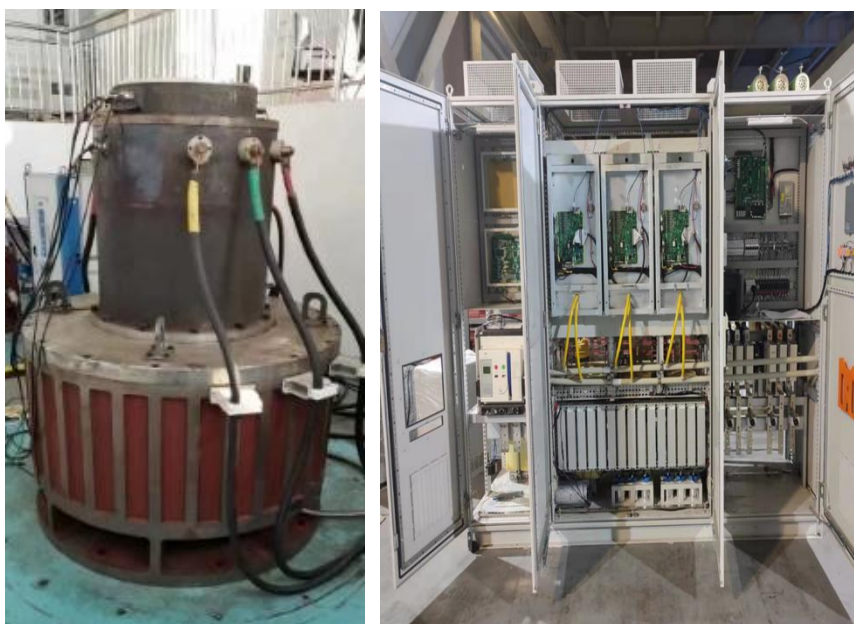
500kW/50kWh 飞轮储能单机装置
