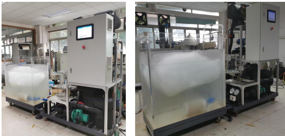
10kW 直接蒸发冰浆机组运行实现温度制冰运行
